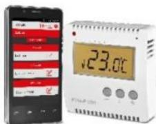
Eignen sich für Wohnungen und Büros mit elektrischer Heizung. Der PT14-P-WiFi kann Direkt-, Infrarotheizungen oder elektrische Fußbodenheizungen bis zu einem Strom von 16 A schalten. Großes Display mit Hintergrundbeleuchtung, einstellbare Hysterese von 0,1 ° C bis 6 ° C, Einstellung eines Wochenprogramms mit 6 Änderungen pro Tag (3 Temperaturen, Spar-, Komfort- und Partytemperatur)
